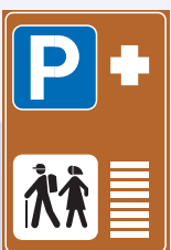
Fig. 371 - Art. 136 Parcheggio di scambio in corrispondenza di itinerari turistici od escursionistici a piedi
