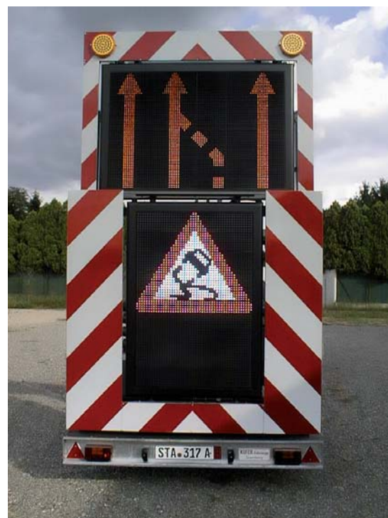
Carrello mobile allestito per segnalazioni luminose con pannelli a led full-color
