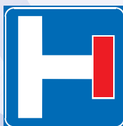
Fig. 311 - Art. 135 Preavviso di strada senza uscita
