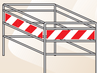
Fig. 402 - Art. 40 Barriera di recinzione per chiusini
