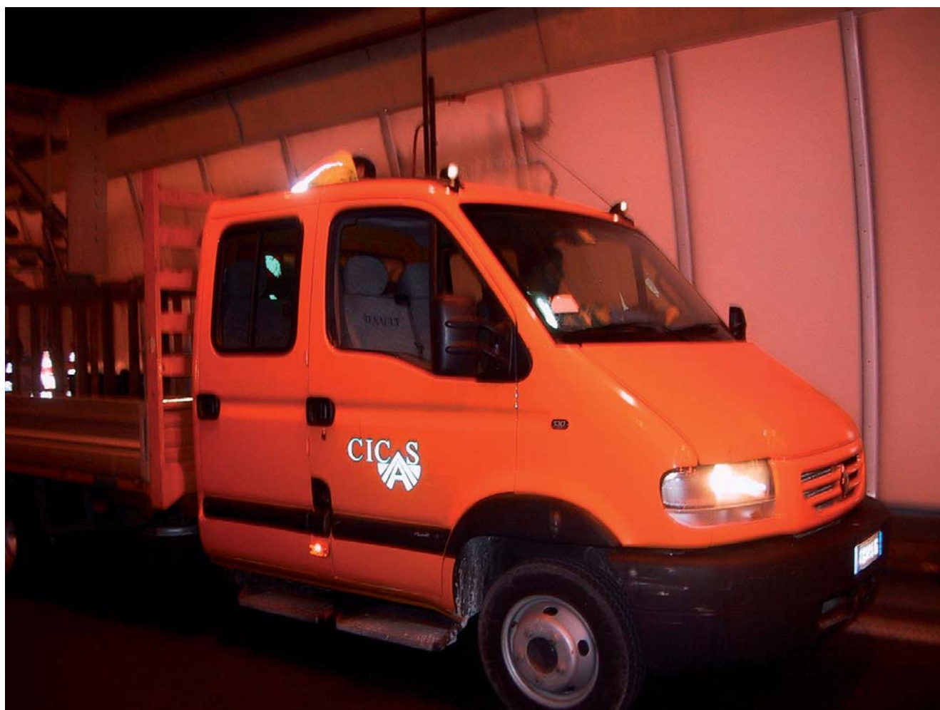
Mezzo operativo al lavoro per la preventiva applicazione di sostanze detergenti sui pannelli di rivestimento galleria
