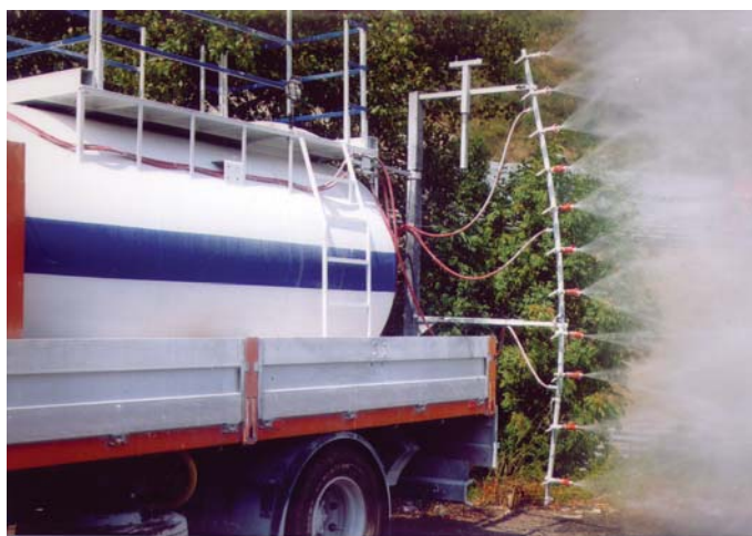
Particolare del gruppo automatico di spruzzatura adibito alla imbiancatura
